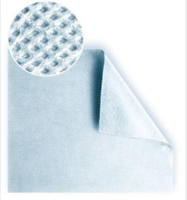
Dichtungsbahn mit dreifacher Polypropylenschicht und monolamellarem Film. Reguliert die in der Luft vorhandene Feuchtigkeit durch die Diffusion von Wasserdampf aufgrund eines Sd-Werts, der zwischen 1 und 12 m liegt. Verhindert das Eindringen der aus den Innenräumen kommenden Feuchtigkeit in die Wärmmisolierung und somit die Bildung von Schimmel bzw. das Faulen des Dachstuhls. Verhindert die Dispersion von Wärmeenergie am Dach, die Bildung von Kondenswasser und die Entstehung von Wärmebrücken.
