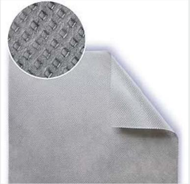
Robuste Dichtungsbahn mit Dampfbremsenfunktion. Wird auf Holzschalung und Beton zur perfekten Regulierung der Dampfdurchlässigkeit verwendet. Dank ihrer Lichtdurchlässigkeit ist sie leicht zu verlegen.
