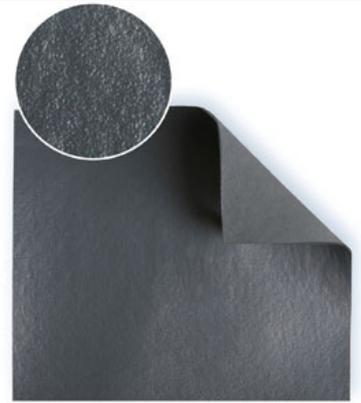
Atmungsaktive Dichtungsbahn aus monolithischen Polyurethanfolien mit zwischenliegender Polyesterschicht. Beständig gegen Wasser, Schlagregen und Wind. Mit Heißluft oder kalt schweißbar.
