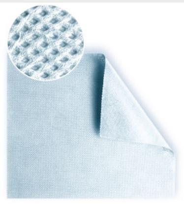
Guaina con triplo strato di polipropilene rinforzato. Regola la quantità di umidità presente nell'aria con la diffusione di vapore acqueo secondo un Sd che varia da 2 a 16 m. Impedisce che l'umidità proveniente dai locali interni penetri nell'isolamento termico causando la formazione di muffe e il disfacimento della struttura del tetto. Impedisce la dispersione di energia termica nella struttura del tetto e la formazione di condensa ed esclude la formazione di ponti termici.
