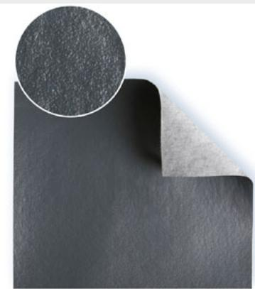
Guaina traspirante pesante, realizzata in tessuto non tessuto di poliestere con una spalmatura di poliolefina, ad alta diffusione di vapore acqueo. Lo speciale rivestimento la rende particolarmente resistente alle lacerazioni e agli strappi da chiodo. È resistente alla pioggia battente in conformità alle severe norme austriache.
