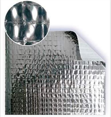
Dampfsperre aus Polyethylen, verstärkt mit Polypropylenetz und Aluminiumschicht. Verhindert die Dampfdiffusion in der Isolierschicht und reflektiert Wärme.
